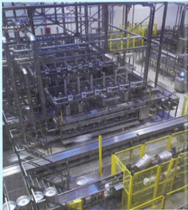
Comac Group stellt auch eine neue speziell für Mikrobrauereien geplante Flaschenanlage vor: wendig, kompakt. Leistungsbereich von 1000 bis 3500 Flaschen pro Stunde. Qualität und Zuverlässigkeit gibt es hier zu einem erschwinglichen Preis. Die Maschinen sind mit energiesparenden Motoren und mit Komponenten ausgestattet, die die wichtigsten Richtlinien zu hygienischem Design erfüllen (z. B. 3-a, FDA und EHEDG).
